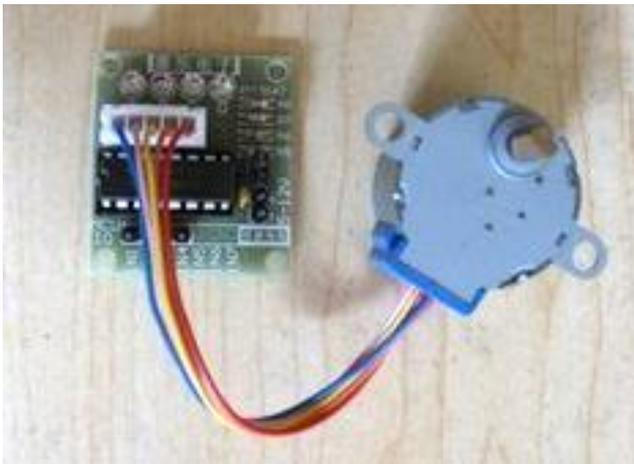
In figura viene proposto il motore passo passo 28YBJ-48, con riduttore incorporato.
