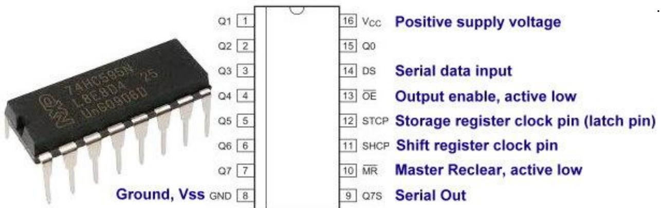
Nell'esercizio 12 abbiamo sfiorato uno dei limiti di Arduino uno, e cioè il numero non elevato di porte di input/output. Tale limite ci ha costretto ad utilizzare porte "anomale", come la 0 e la 1 per riuscire a pilotare un display a 4 cifre. Il chip 74HC595 offre una soluzione a questo problema poiché, utilizzando tre sole porte Arduino può pilotare ben 8 porte, alle quali è possibile collegare dei led o degli attuatori a basso assorbimento di energia.
